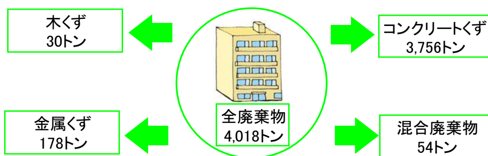
図3 マンションの解体に伴う建設廃材排出量
